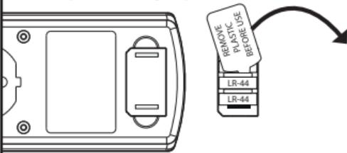
Return battery-compartment / Plaats batterijvak terug
